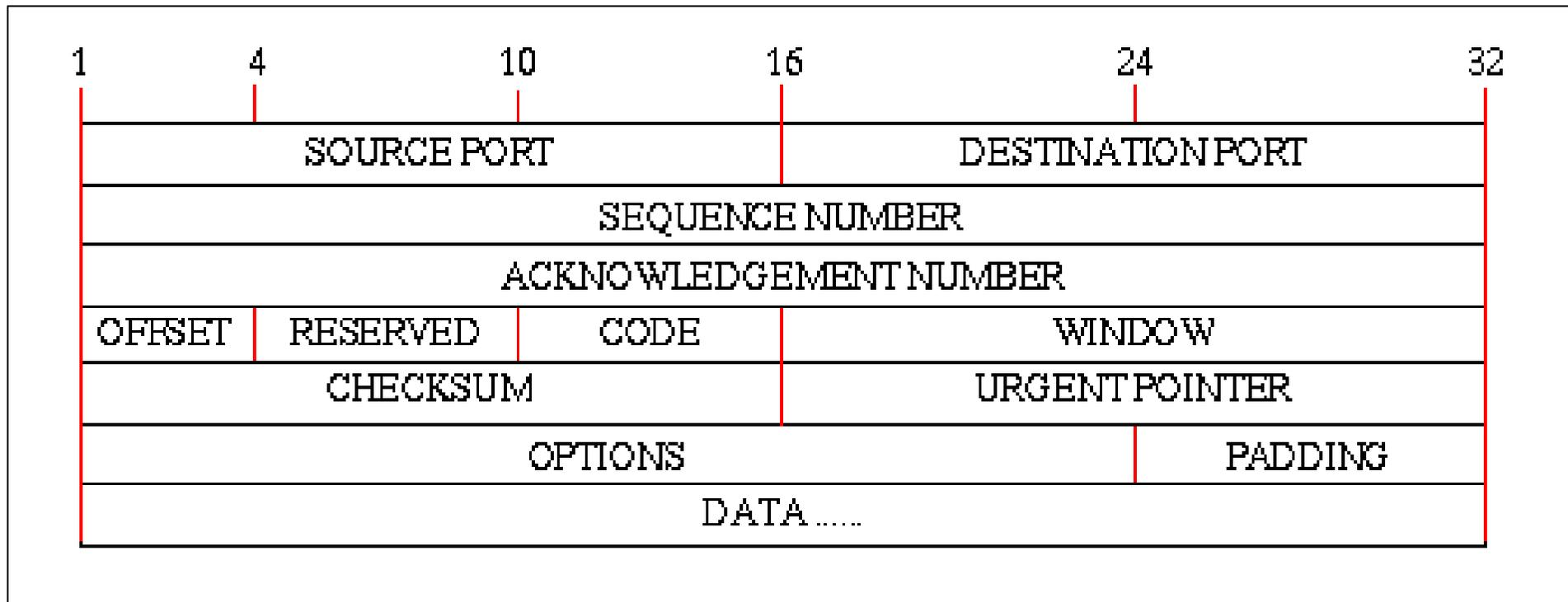
Figure A-9. TCP Segment Header Format.
